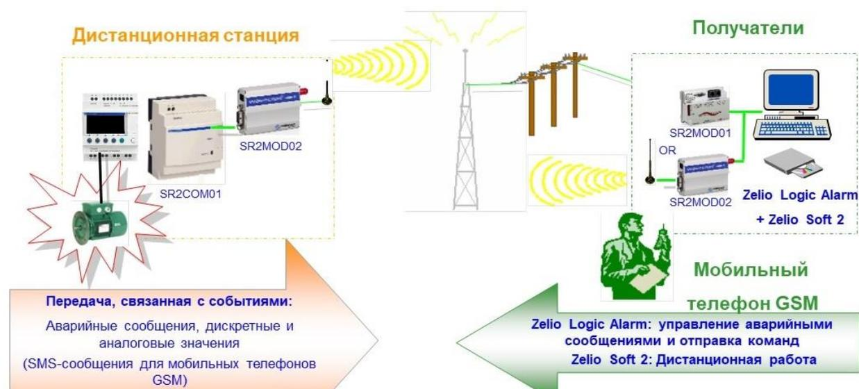
Рисунок 3.6 - Общая система связи с помощью GSM
