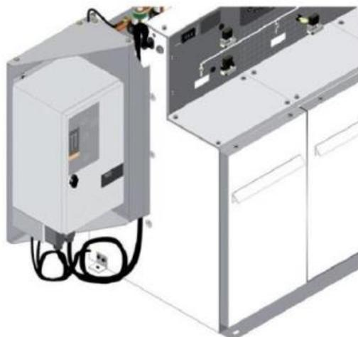
**Рисунок 2.23 – Возможность установки системы АВР/АСО**
